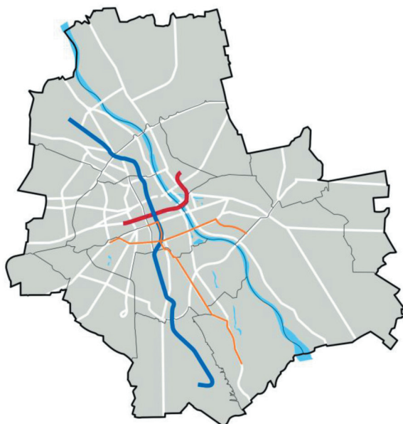
Rys. 3. Mapa sieci metra i metrobusu w Warszawie (kolorem niebieskim oznaczono I linię metra, kolorem czerwonym II linię, a kolorem pomarańczowym proponowany przez autora przebieg linii metrobusowych)
