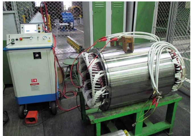
Rys. 10. Pomiary stojana uzwojonego cyfrowym testerem uzwojeń
