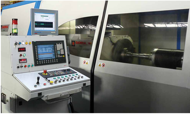
Rys. 8. Szlifowanie stopni wału na wirniku z pomiarem Marposh
