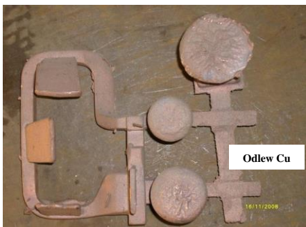
Rys. 9. Odlew uzwojenia pierwotnego z miedzi
