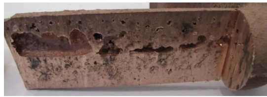
Rys. 11. Porowatość w przekroju odlewu z miedzi wykonanego metodą wytapianych modeli z wytopów bez zastosowania zabiegów uszlachtniania kąpielą metalową
