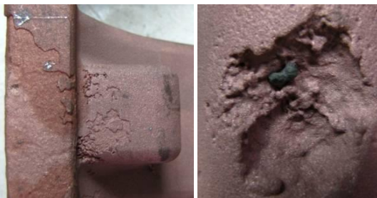
Rys. 10. Wady powierzchniowe powstałe w procesie odlewania miedzi
