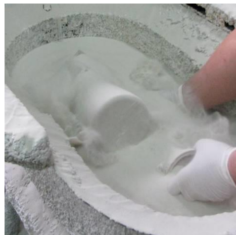
Rys. 3. Nakładanie powłoki ceramicznej na modelach uzwojenia
