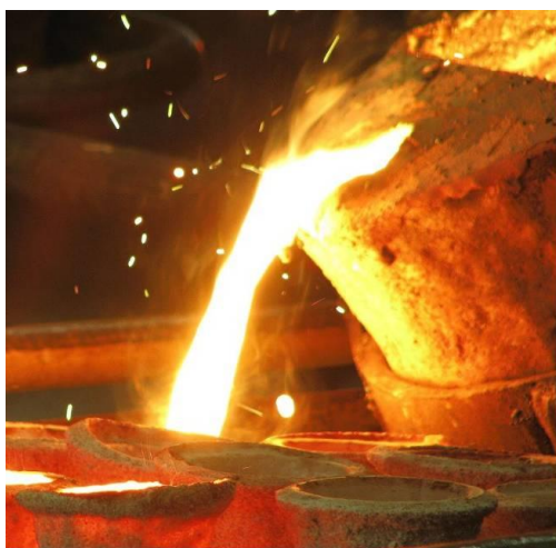
Rys. 4. Zalewanie form ceramicznych ciekłym metalem
