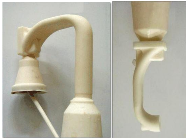
Rys. 2. Przykładowe modele woskowe na odlewy uzwojeń pierwotnych
