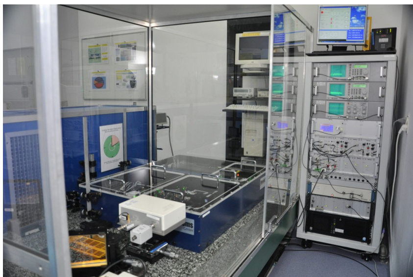
Rys. 4. Syntezator częstotliwości optycznych (pierwotny wzorzec długości)
