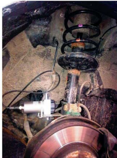
2 pav. Kairėje – amortizatorių efektyvumo matavimas stende „Safeline 400/800“. Dešinėje – Automobilio pakabos eigos matavimas
