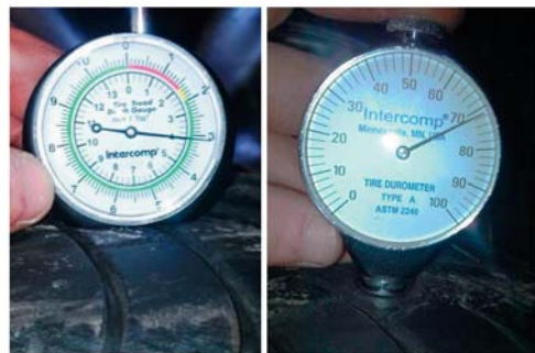
4 pav. Vasarinės padangos protektoriaus gylis ir gumos kietumas
