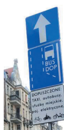
Fot. 4. Znak BUS DOP – oznakowanie pionowe na ul. Garbary z białą tabliczką podznakową (dopuszczony również ruch rowerowy) Źródło: zdjęcia własne
