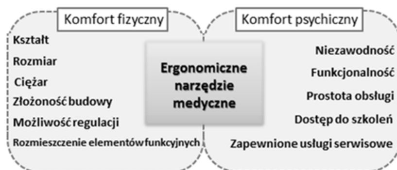
Rys. 23.2 Czynniki wpływające na zaspokojenie potrzeb komfortu fizycznego i psychicznego w odniesieniu do ergonomii narzędzi medycznych
