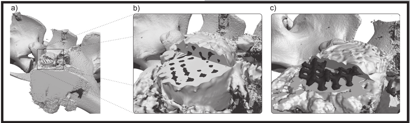
RYS. 3. CTt biostabilizacji (a) z obrostem kostnym implantu chirurgicznie w ok. 80% osadzonego w kości (b) z celowo wypukloną kratownicą Ti-3D-Truss modelu poprzez miejscowe „usunięcie” kości z użyciem funkcji oprogramowania inżynierskiego (c); obszary ciemne – biomateriał, jasne – tkanka kostna.
