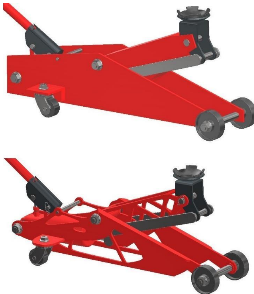
Rys. 7. Model bryłowy Podnośnik samochodowy przed (góra) oraz po (dół) optymalizacji [4]
