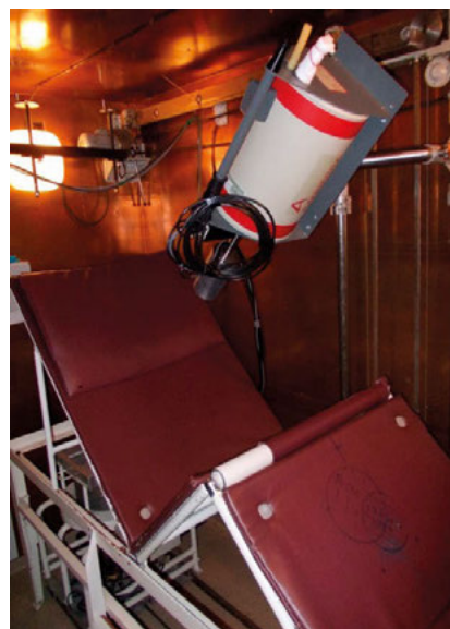
Rys. 2 Wnętrze komory Licznika Całego Ciała w NCBJ Źródło: Archiwum autorów.
