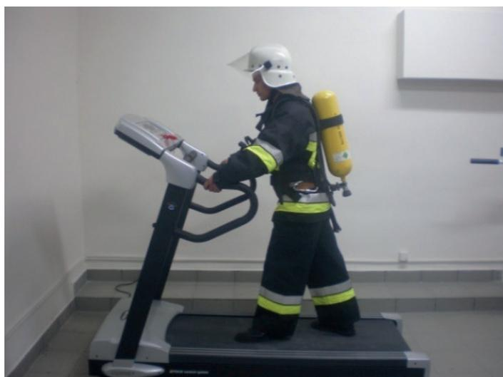
Рис. 3. Волонтер в процессе испытания костюма на беговой дорожке
