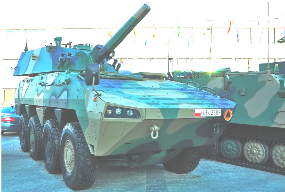
Rys. 1. 120 mm moździerz samobieżny Rak na podwoziu KTO Rosomak (fot. HSW-CPW)
