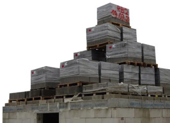
Rys. 9. Widok modelu pod maksymalnym obciążeniem – próba zniszczenia
