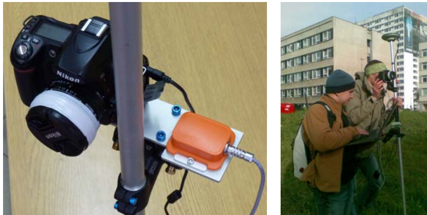
Rys. 1. Po lewej: aparat fotograficzny i jednostka AHRS zamontowane na tyczce anteny GPS. Po prawej: prototyp systemu podczas wykonywania pomiarów na obiekcie testowym
