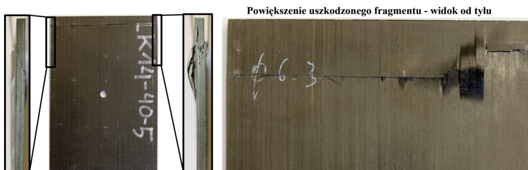
Rys. 8. Próbką z otworem o średnicy \phi 6,3 mm po próbie ściskania - LK14-40-5 (opracowanie własne 2016)
