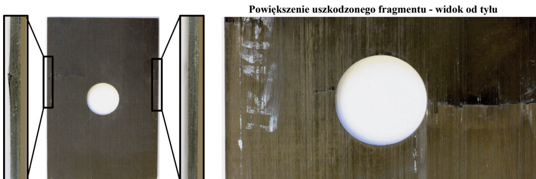
Rys. 11. Próbką z otworem o średnicy \varnothing 30 mm po próbie ściskania - LK14-39-1 (opracowanie własne 2016)
