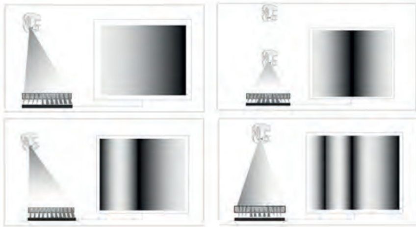
Rys. 5 Zestawienie przykładowych błędnych ustawień lampy RTG względem kratki przeciwrozproszeniowej oraz wywołane tym efekty na obrazie Źródło: https://slideplayer.com/slide/9936090/ .
