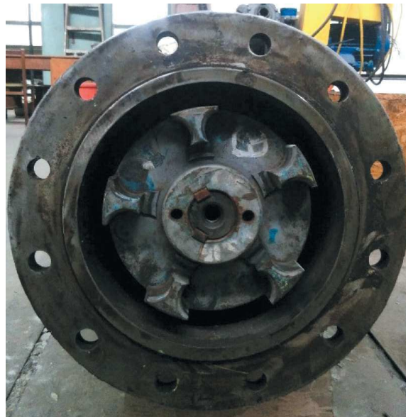
Rys. 2. Widok członu biernego sprzęgła wkładkowego zastosowanego w organie urabiającym kombajnu chodnikowego
