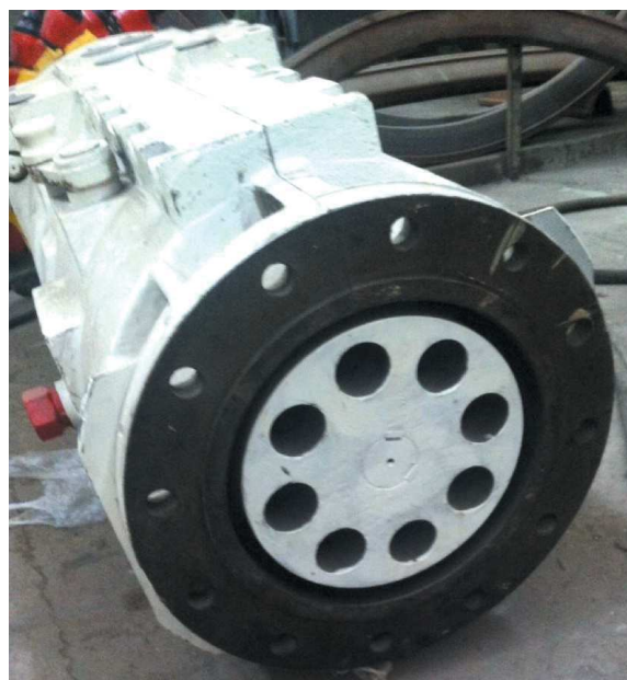
Rys. 3. Widok członu biernego sprzęgła palcowego zastosowanego w organie urabiającym kombajnu chodnikowego
