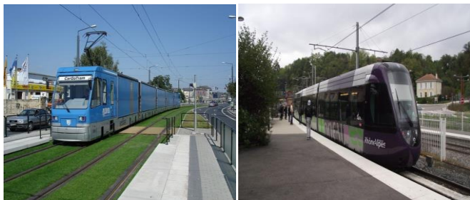
Rys. 1. Tramwaj towarowy CarGoTram w Dreźnie i tramwaj dwusystemowy w l'Arbresle pod Lyonem 19.
