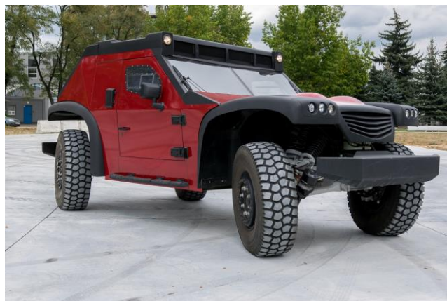
Rys. 6. Wielofunkcyjny pojazd do zadań specjalnych FUNTER - koła skręcone do jazdy bokiem tzw. „psi chód”
