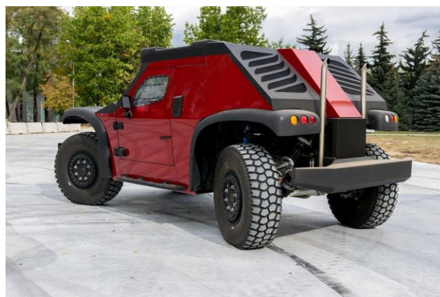
Rys. 7. Wielofunkcyjny pojazd do zadań specjalnych FUNTER - koła skręcone z przeciwną stroną w celu zmniejszenia promienia skrętu
