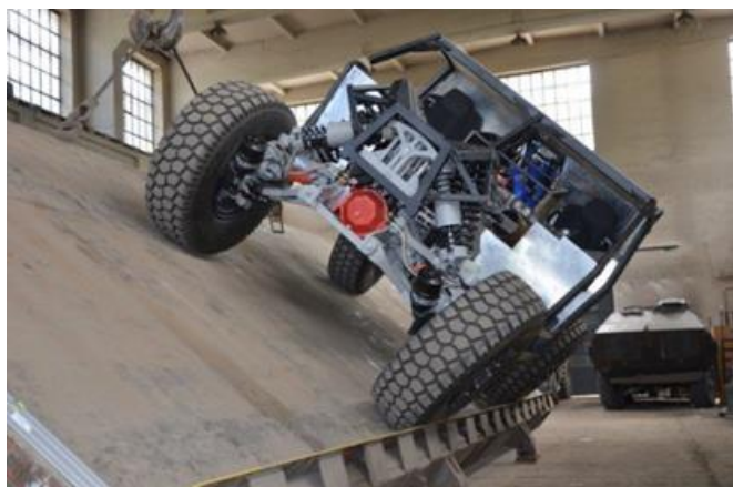
Rys. 5. Wielofunkcyjny pojazd do zadań specjalnych FUNTER w czasie badań – przechylt poprzeczny
