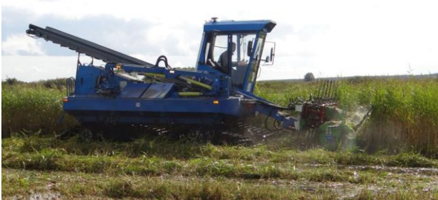
Rys. 4. Model rzeczywisty nowej wersji modułu koszącego zamontowany na pojeździe gąsienicowym PIMR podczas koszenia trzciny [archiwum PIMR-BE]
