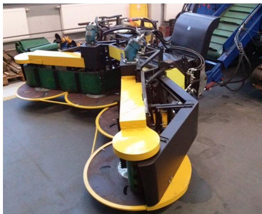
Rys. 9. Nowa wersja zespołu pił tarczowych [archiwum PIMR-BE]
