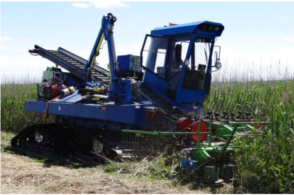
Rys. 2. Moduł do koszenia traw i trzciny zamontowany na specjalistycznym pojeździe gąsienicowym PIMR podczas badań
