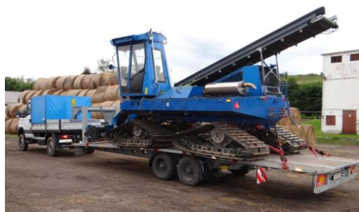
Rys. 1. Zestaw pojazdów samochodowych PIMR podczas transportu specjalizowanego pojazdu gąsienicowego [archiwum PIMR-BE]
