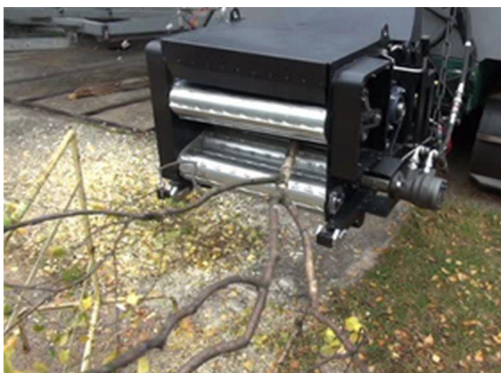
Rys. 8. Rozdrabniacz bębnowy podczas testów laboratoryjnych [archiwum PIMR-BE]
