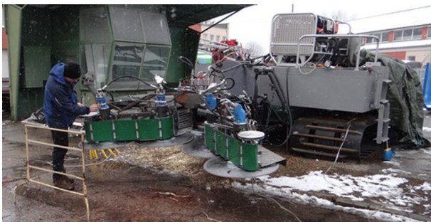
Rys. 7. Zespół pił tarczowych do usuwania zakrzaceń podczas prób stanowiskowych [archiwum PIMR-BE]
