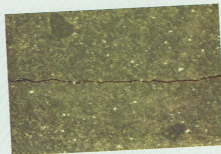
Fot. 7. Mikrostruktura masy ceramicznej z widocznymi ziarnami kwarcu oraz podłużnym spękaniem, pow. 45x (fot. H. Stoksik)
