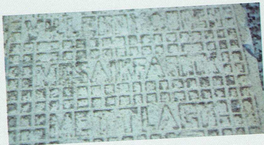
Fot. 2. Spodnia powierzchnia płytki ceramicznej z dobrze czytelną nazwą producenta „Mosaikfabrik Mettlach”
