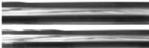
Rys. 9. Widok z boku dla struktury falowej Fig. 9 Side view of the wavy flow
