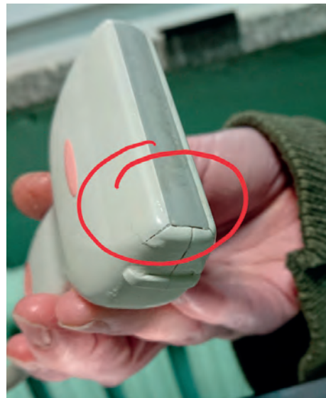
Rys. 4 Pęknięcia obudowy głowicy. Pęknięcia mogą doprowadzić do zasychania żelu w szczelinach, co prowadzi do dalszego rozsądzania plastikowej obudowy i w rezultacie zniszczenia głowicy Źródło: Archiwum własne.
