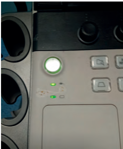
Rys. 2 Zabrudzenia i przetarcia panelu sterowania Źródło: Archiwum własne.
