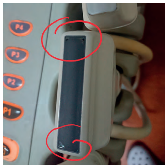
Rys. 5 Przetarcia na rogach soczewki głowicy USG Źródło: Archiwum własne.
