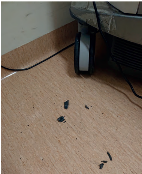
Rys. 1 Uszkodzenie mechanizmu jezdnego aparatu USG Źródło: Archiwum własne.
