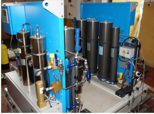
Rys.1-2 Konfiguracja zestawu zasilania i uzdatniania powietrza oddechowego DGKN – 120. Źródło: opracowanie własne.
