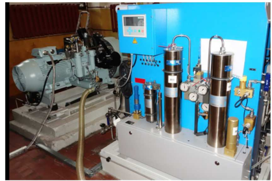
Rys.1-2 Konfiguracja zestawu zasilania i uzdatniania powietrza oddechowego DGKN – 120. Źródło: opracowanie własne.
