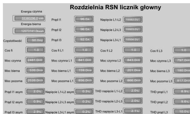
Rys. 5 Mierzone wartości parametrów sieci zasilającej w polu zasilającym GPZ
