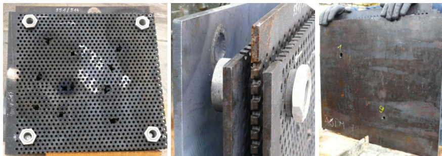
Rys. 6. Pancerz mrożony, ostrzelany 11 pociskami 14,5 mm B32 pod kątem 0° od normalnej do jego powierzchni
