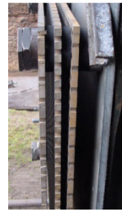
Rys. 4. Pancierz ostrzelany 15 pociskami 14,5 mm B-32 pod kątem 0^\circ od normalnej do jego powierzchni
