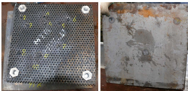
Rys. 7. Pancerz mrożony, ostrzelany 10 pociskami 14,5 mm B-32 pod kątem 0^\circ od normalnej do jego powierzchni
