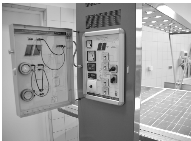
Rys. 4. Tablica sterująca stanowiskiem badawczym Fig. 4. The control board of the laboratory stand
