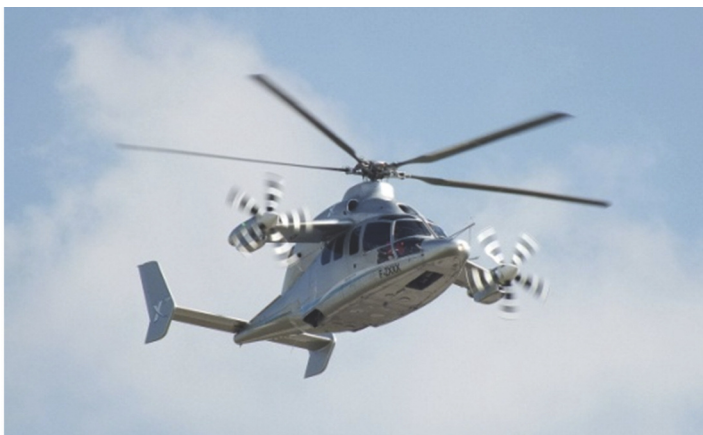
Rys. 2. Śmigłowiec compound EUROCOPTER X3 [2]
