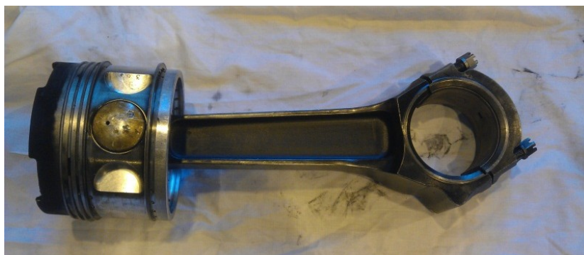
Rys. 3. Kompletny korbowód i tłok pochodzące z analizowanego silnika Fig. 3. The complete connecting-rod and a piston from the engine analyzed
