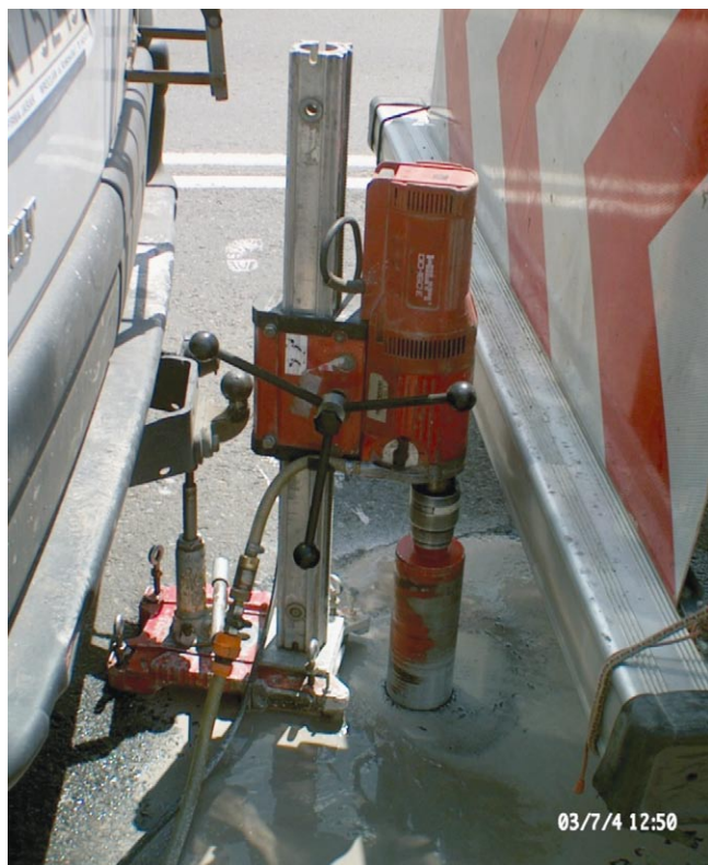
Rys. 2. Widok sposobu wycinania odwiertu rdzeniowego z płyty pomostowej obiektu mostowego
