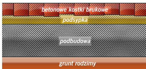
Rys. 1. Schemat właściwie przygotowanej podsypki – równa nawierzchnia
