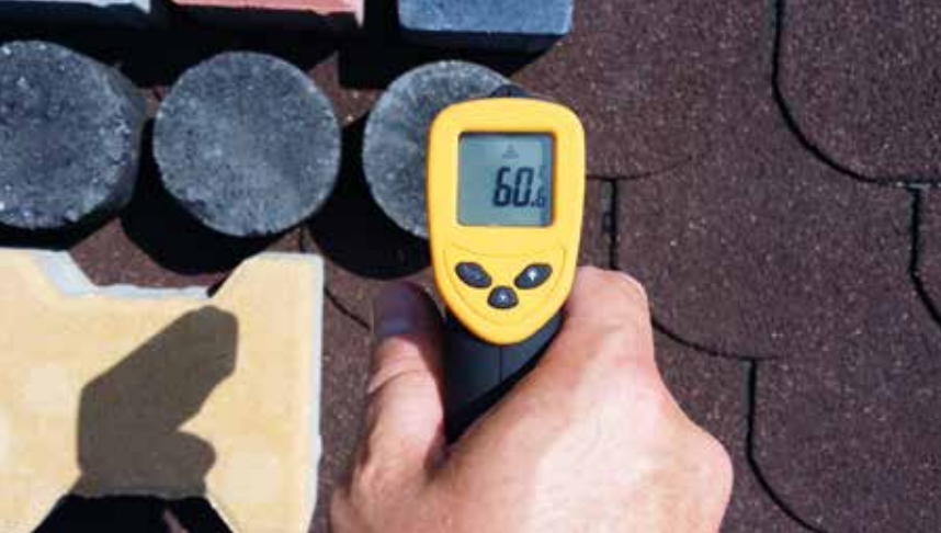
Fot. 6. Pomiar temperatury powierzchni próbki asfaltowej
