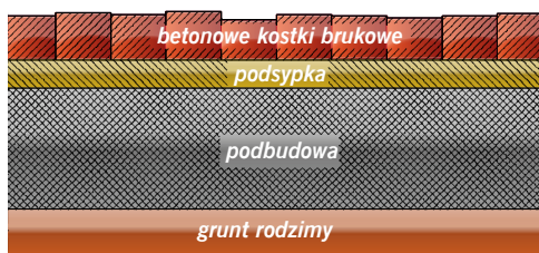
Rys. 2. Schemat niewłaściwie przygotowanej podsypki – nierówna nawierzchnia
