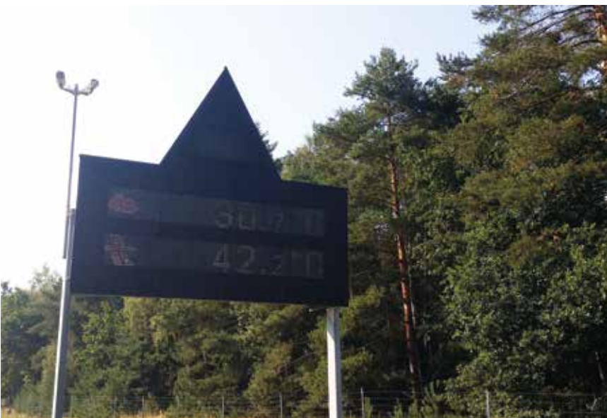
Fot. 5. Przykład różnicy temperatur pomiędzy temperaturą powietrza i nawierzchni asfaltowej autostrady A-4 – sierpień 2014
