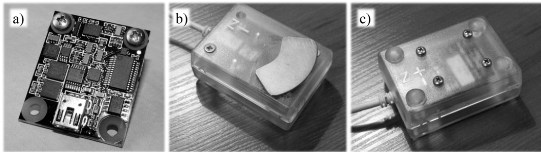
Fig. 4. a) PHIDGET 1056 measuring circuit, b, c) measuring head with magnetic holder Rys. 4. a) Układ PHIDGET 1056, b, c) głowica pomiarowa z uchwytem magnetycznym
