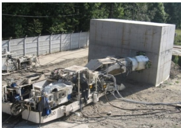
Rys. 16.6 Testy głowicy dyskowej z udziałem kombajnu FR 250 Źródło: Materiały własne
