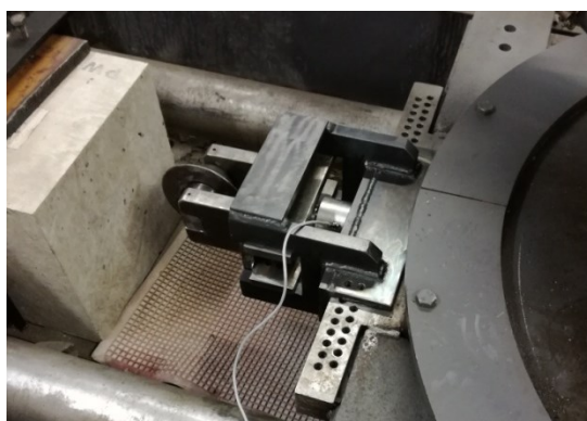
Rys. 16.3 Stanowisko do badań urabiania pojedynczym narzędziem dyskowym Źródło: Materiały własne
