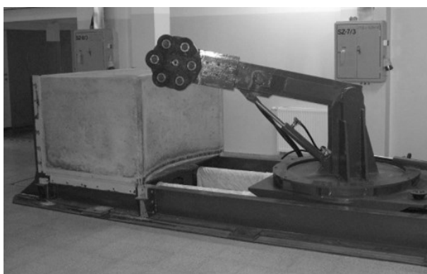
Rys. 16.4 Stanowisko do badań procesu urabiania tarczą dyskową Źródło: [8]
