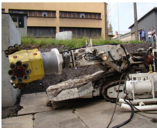
Rys. 16.5 Badania głowicy dyskowej z wykorzystaniem kombajnu KR 150 Źródło: Materiały własne
