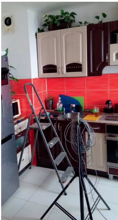
Fot. 3. Pomiar poziomu hałasu w pokoju z aneksem kuchennym
