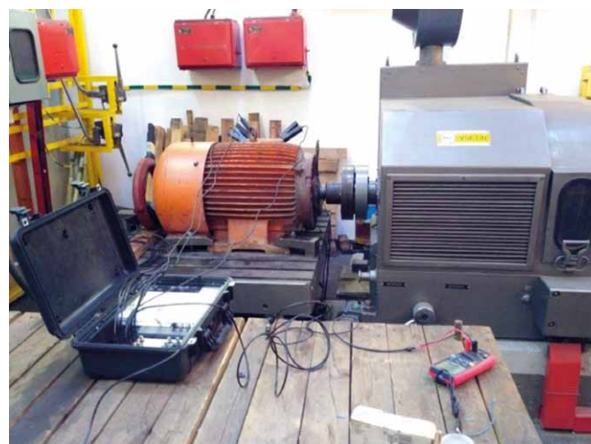
Rys. 3. Silnik obciążony na stanowisku w stacji prób
