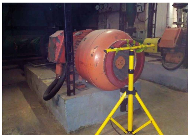
Rys. 2. Sposób pomiaru strumienia poosiowego na stanowisku pracy - cewka na statywie
