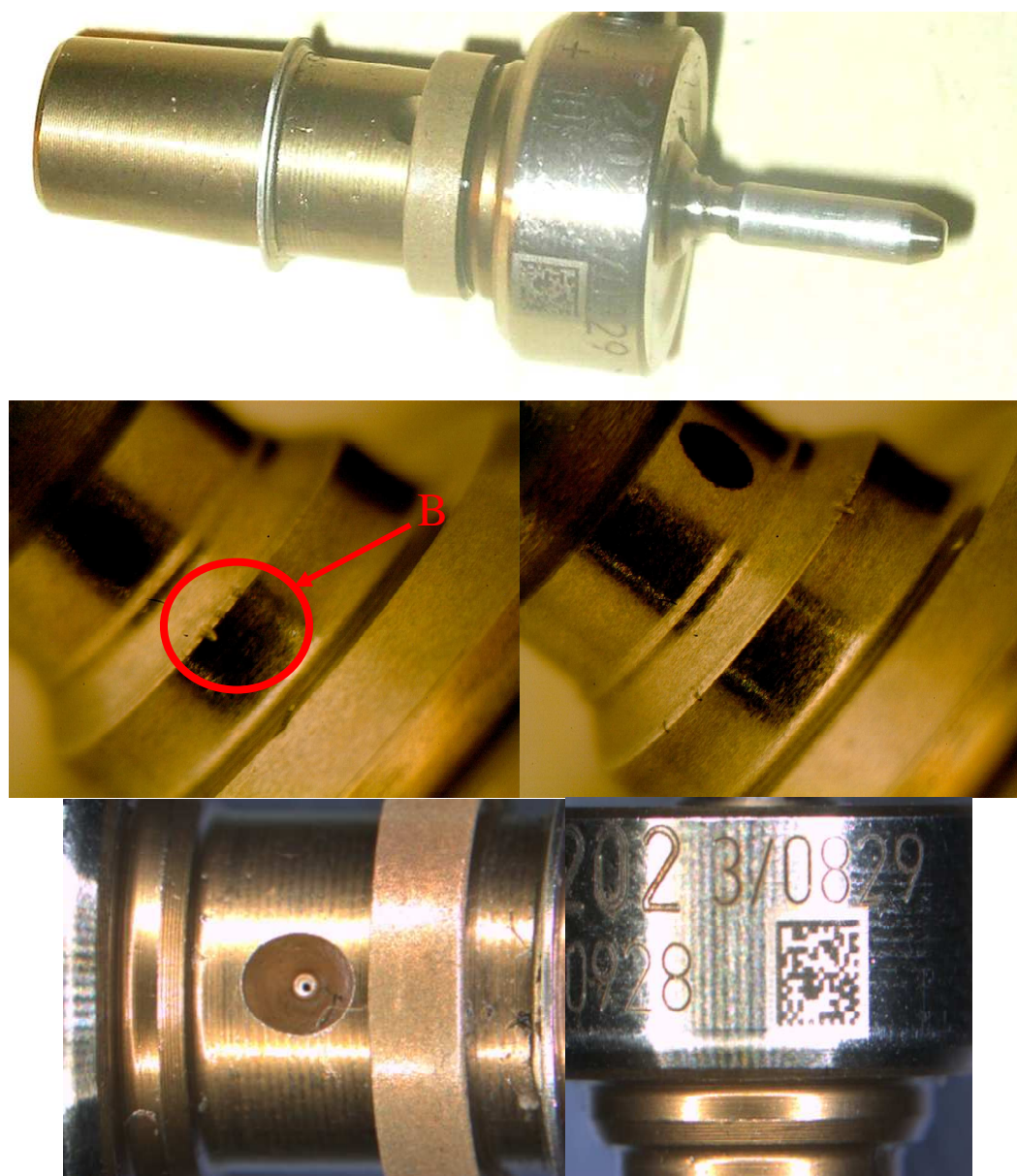
Rys. 6. Uszkodzenia grzybka zaworu (elementu zamykającego) badanego wtryskiwacza
