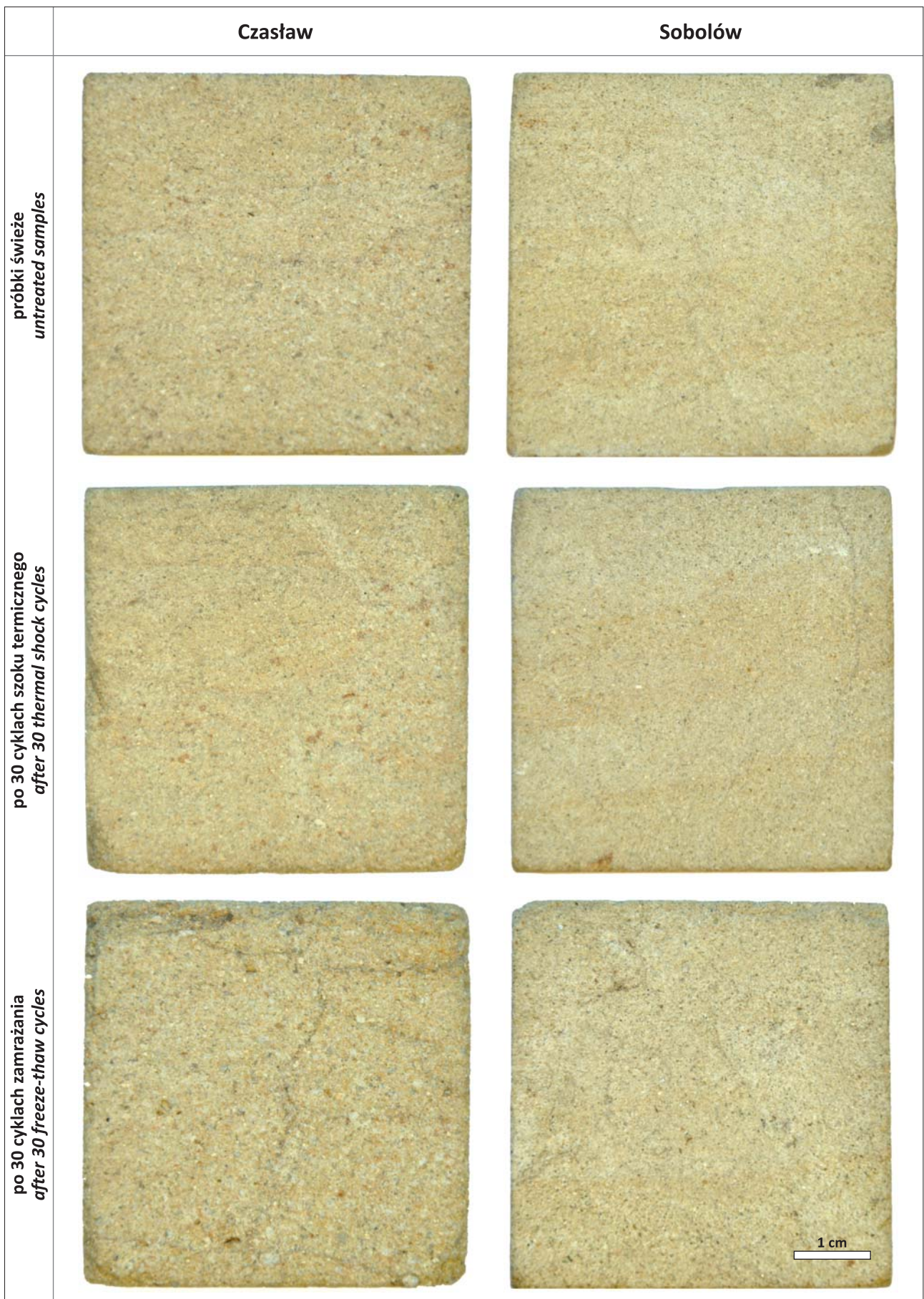
Ryc. 2. Próbkę piaskowca istebniańskiego ze złóż Czasław i Sobolów: świeże, po 30 cyklach szoku termicznego i 30 cyklach zamrażania Fig. 2. Samples of the Istebna sandstones from the Czasław and Sobolów deposits in a sequence: untreated, after 30 thermal shock cycles, after 30 freeze-thaw cycles
