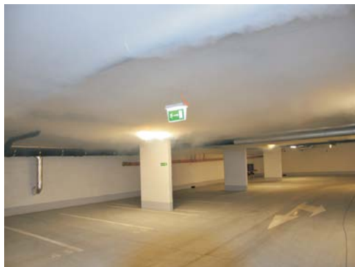
Ryc. 8. Opadanie dymu w pobliżu ściany budynku zaobserwowane w obliczeniach numerycznych oraz podczas prób z gorącym dymem [1]
