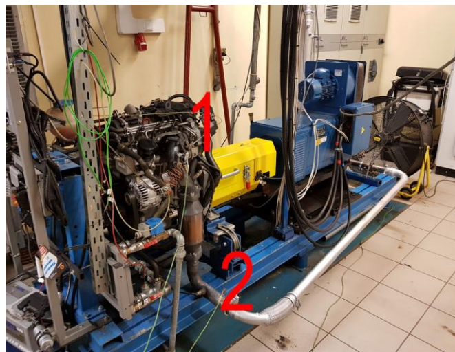
Rys. 4. Widok silnika na stanowisku hamulcowym; cyfry 1 i 2 oznaczają położenie punktów pomiarowych
