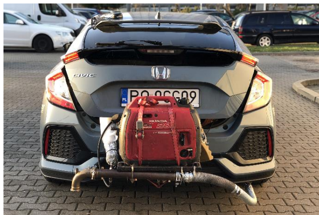
Rys. 5. Widok pojazdu użytego do pomiaru wskaźników pracy silnika w teście RDE
