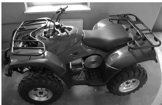
Rys.1. Elektryfikowany pojazd terenowy Quad. Pod siedzeniem kierowcy widoczny jest silnik PMSM.
