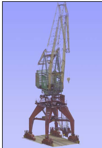
Rys. 1. Połączone i pokolorowane chmury punktów skanowanego dźwigu
