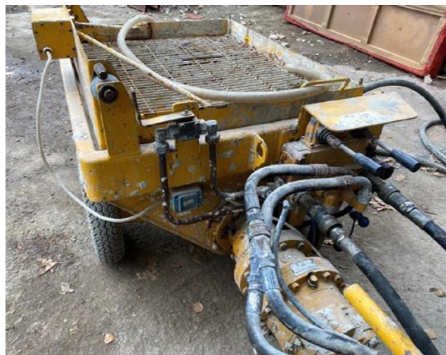
Rys. 8. Pompa śrubowa z napędem hydraulicznym, za pomocą której materiał był dostarczany na miejsce montażu (fot. autora)
