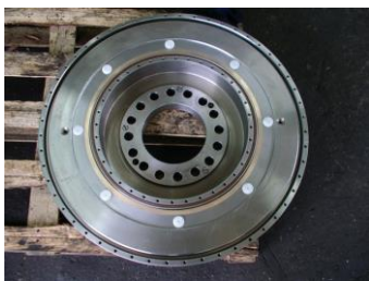
Rys. 2. Wiskotyczny tłumik drgań skrętnych - widok z zamkniętą pokrywą [1,4]
