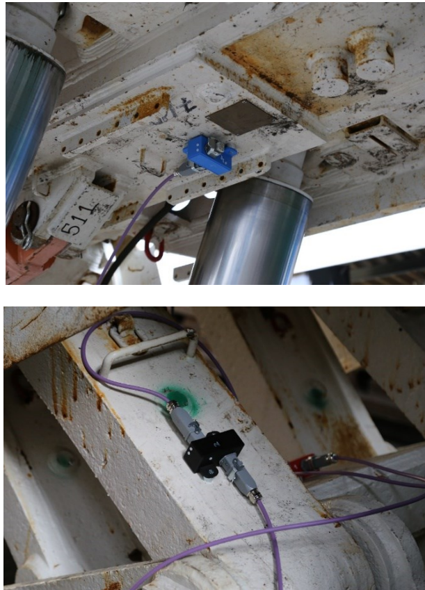
Rys. 22.4 Model inklinometrów zabudowane na sekcji obudowy zmechanizowanej
