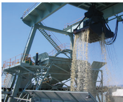
Fig. 7. Extraction of gravel and sand aggregates with a grab dredger Rys. 7. Wydobycie kruszyw żwirowo-piaskowych pogłębiarką chwytakową
