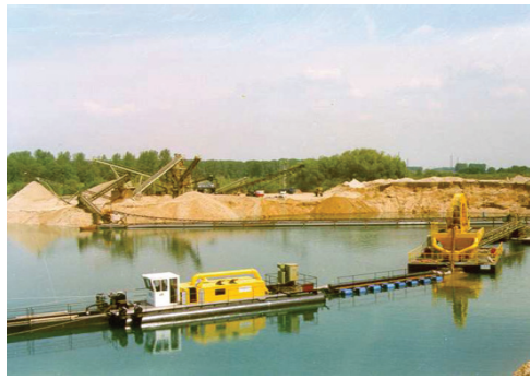
Fig. 5. Extraction of gravel and sand aggregates with a suction dredger Rys. 5. Wydobycie kruszyw żwirowo-piaskowych pogłębiarką ssącą
