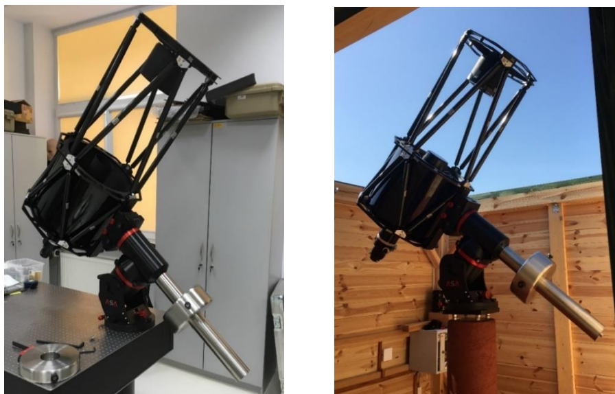
Rys. 2. Teleskop NFOV na stanowisku testowym: laboratoryjnym i polowym
