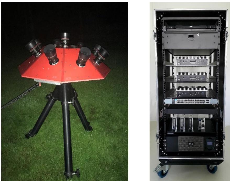
Rys. 1. Montaż mechaniczny dla teleskopu szerokokątnego WFOV – obok szafa z systemem komputerów sterujących oraz serwerem czasu
