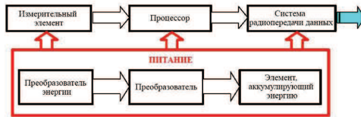
Рис. 7. Схема беспроводного датчика [1]
