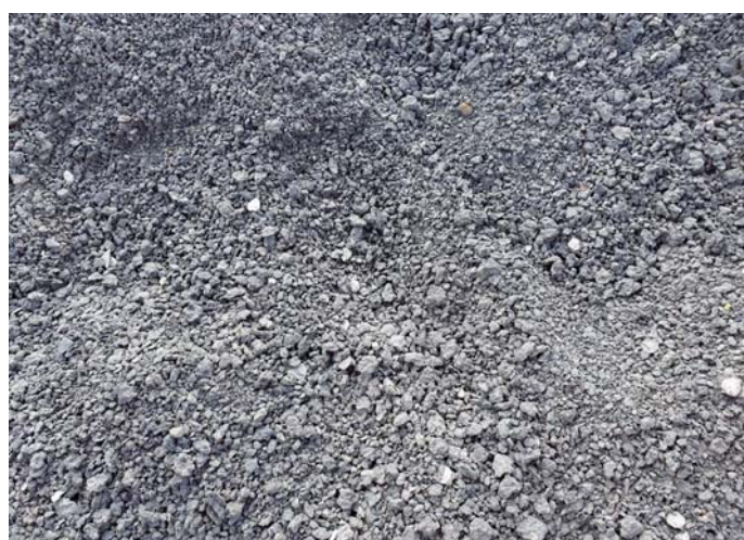
Fot. 2. Granulat asfaltowy 22 GRA 0/16 stosowany przy produkcji mieszank mineralno-asfaltowych
