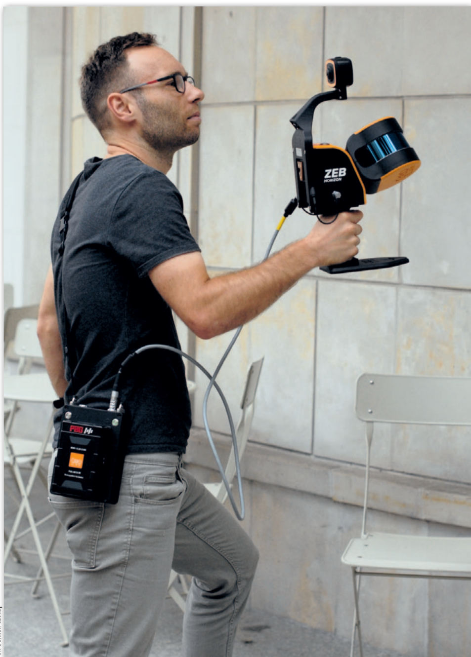
Rys. 1. W trakcie redakcyjnego testu skanera Zeb Horizon
