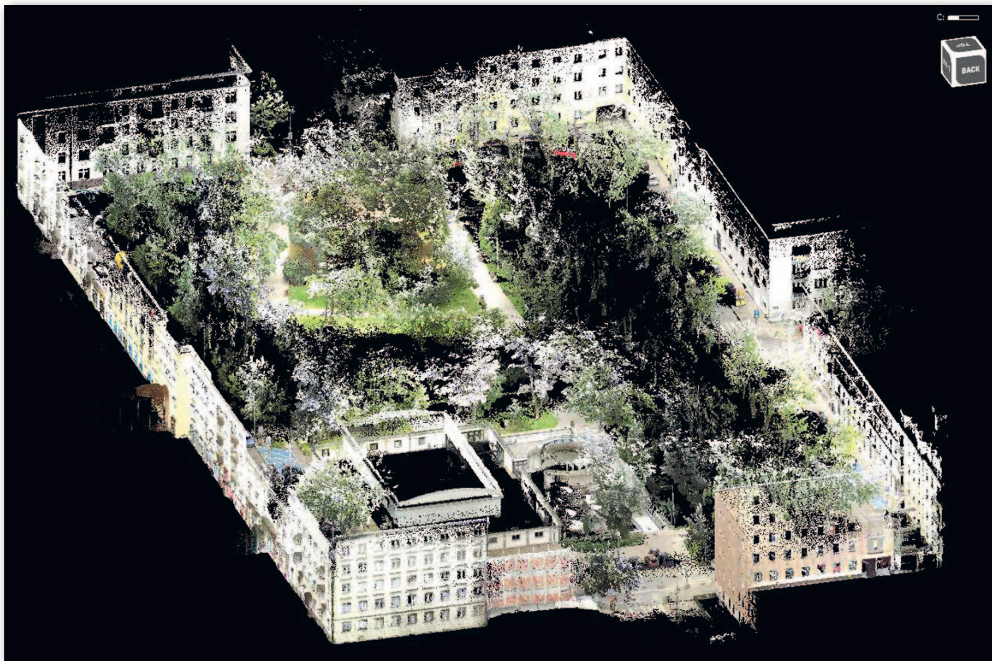
Rys. 4. Pokolorowana chmura punktów dla skweru Słonimskiego na Górnym Mokotowie
