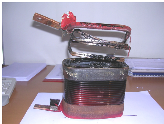
Rys. 6. Przegrzana cewka uzwojenia
